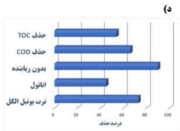
شکل ۲: (الف-ج) شکل سه بعدی تاثیر برهمکنش پارامترها روی حذف سفتریاکسون؛ (د) تغییرات بازدهی حذف سفتریاکسون در حضور ریاپنده، تغییرات حذف COD و TOC
