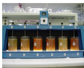
ب) دستگاه جارتست (فرایند انعقاد شیمیایی متداول)
