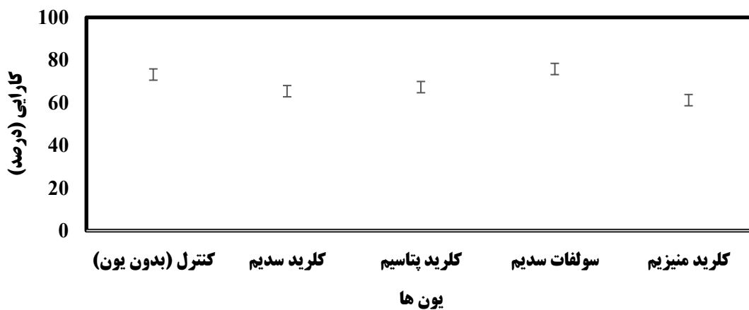
شکل ۶. تاثیر حضور یون های معدنی بر کارایی فرایند پلاسمای سرد اتمسفری در شرایط بهینه (pH=۶/۶، ولتاژ=۲۵ کیلوولت، جریان هوای ورودی=۱۴ لیتر در دقیقه، غلت اولیه میکروپلاستیک=۵۰۰ ذره در لیتر)
