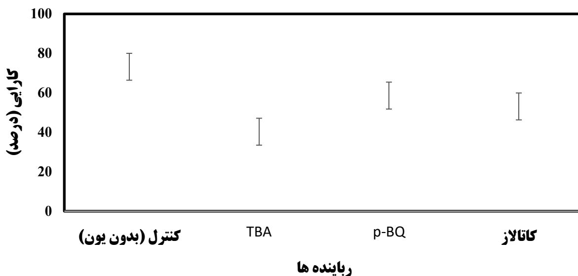
شکل ۵. تاثیر راینده های رادیکال بر کارایی فرایند پلاسمای سرد اتمسفری در شرایط بهینه ( pH=6/6 ، ولتاژ=۲۵ کیلوولت، جریان هوای ورودی=۱۴ لیتر در دقیقه، غلت اولیه میکروپلاستیک=۵۰۰ ذره در لیتر)
