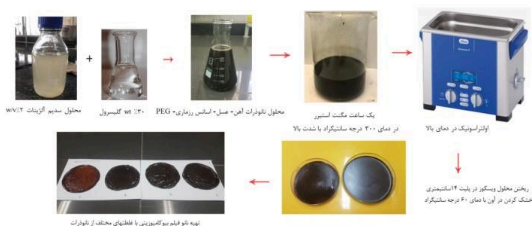
شکل ۲. مراحل تولید ورقه های نانوفیلمی جاذب بیوکامپوزیتی آلزیناته از نانوذر اکسید آهن مگنتیت
