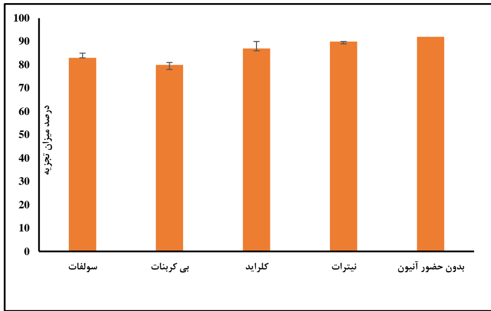
شکل ۵ الف: تأثیر اسکاونجرهای رادیکال OH در تخریب مترونیدازول توسط UZS (نسبت مولی اکسید روی/سولفیت ۱:۳، زمان تماس ۵ دقیقه، غلظت مترونیدازول ۱ میلی گرم بر لیتر، غلظت اسکاونجر ۱ میلی مولار برلیتر).
