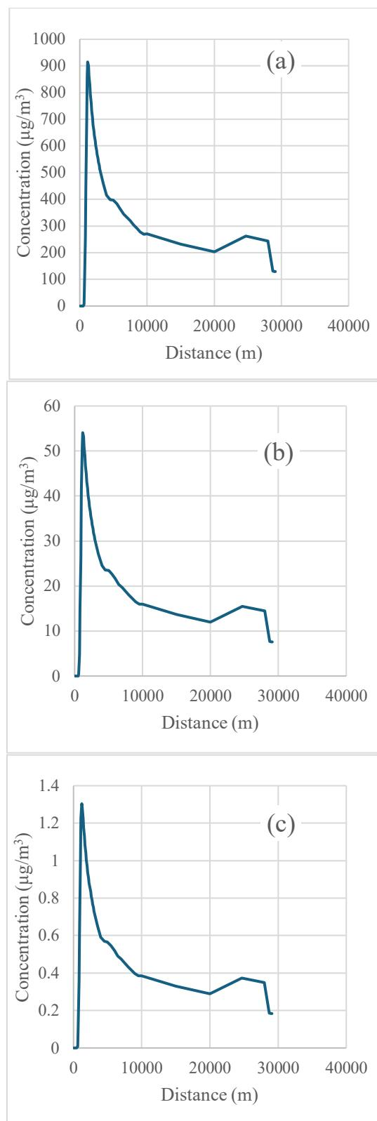
شکل ۴. حداکثر غلظت آلاینده‌ها بر حسب فاصله از دودکش در جهت‌های جنوب‌شرقی: (a) CO، (b) NO<sub>2</sub> و (c) SO<sub>2</sub>
