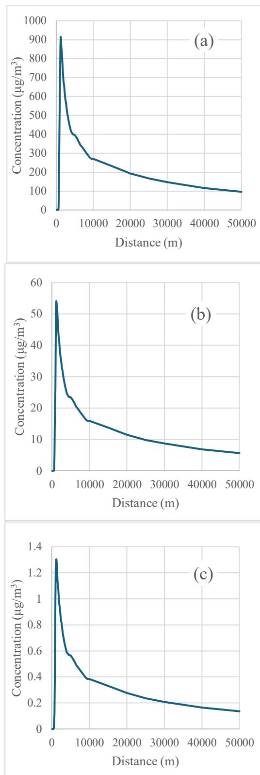
شکل ۳. حداکثر غلظت آلاینده‌ها بر حسب فاصله از دودکش در جهت‌های جنوب‌غربی و جنوب: (a) CO، (b) NO<sub>2</sub> و (c) SO<sub>2</sub>
