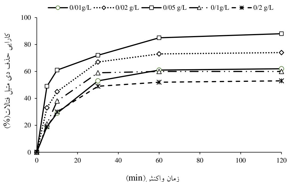
شکل ۴: تأثیر میزان  $\text{nZVI}$  در حذف DMP (۱۰ mg/L:nZVI، pH=۴، غلظت  $\text{H}_2\text{O}_2$  ۰/۱ mmol/L)
