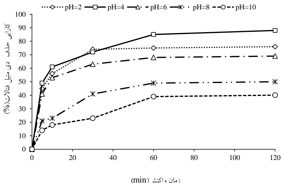
شکل ۲: تأثیر pH در حذف دی متیل فتالات (غله DMP ۰/۰۵ gr/L، nZVI ۰/۱ mmol/L، H<sub>2</sub>O<sub>2</sub> ۱۰ mg/L، میزان DMP ۰/۰۵ gr/L)
