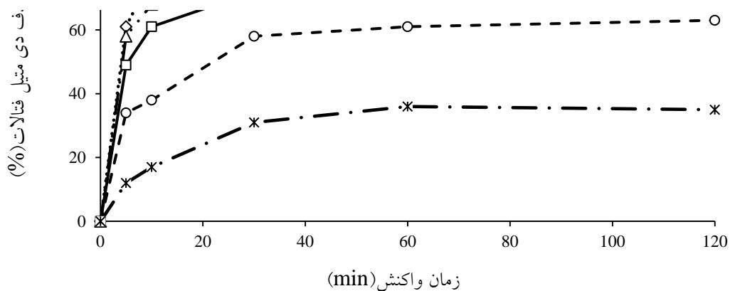
شکل ۵: تأثیر غلظت اولیه DMP در حذف آن (pH=۴، میزان nZVI: H<sub>2</sub>O<sub>2</sub>=۰/۰۵ gr/L: mmol/L، میزان DMP=۰/۱ mmol/L)
