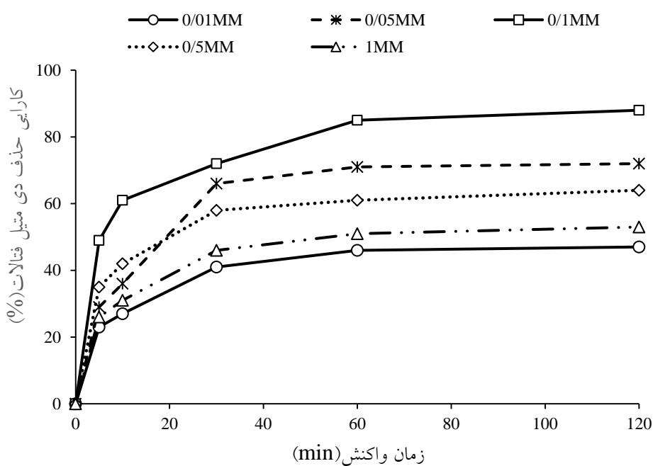
شکل ۳. تأثیر غلظت  $\text{H}_2\text{O}_2$  در حذف DMP (۱۰ mg/L:nZVI، pH=۴، غلظت DMP ۰/۰۵ gr/L)
