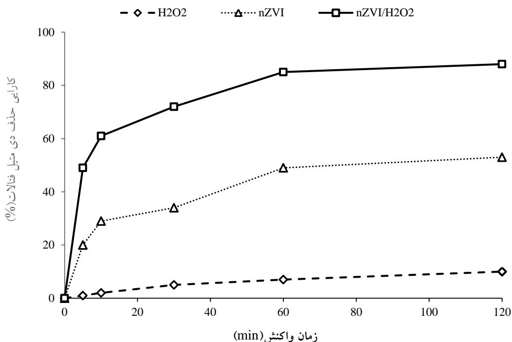
شکل ۶. تأثیر  $\text{H}_2\text{O}_2$ ، nZVI و  $\text{nZVI}/\text{H}_2\text{O}_2$  در حذف DMP (غله DMP میزان  $0.1\text{ mmol/L}$ : $\text{H}_2\text{O}_2$ ،  $\text{pH}=4$ ،  $2\text{ mg/L}$ )
