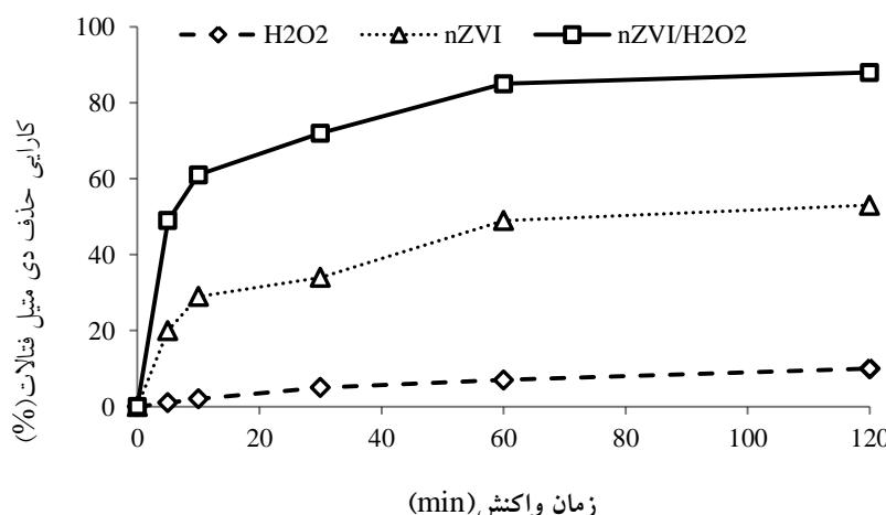
شکل ۵: تأثیر  $\text{H}_2\text{O}_2$  و  $\text{nZVI}/\text{H}_2\text{O}_2$  در حذف دی‌متیل‌فتالات
