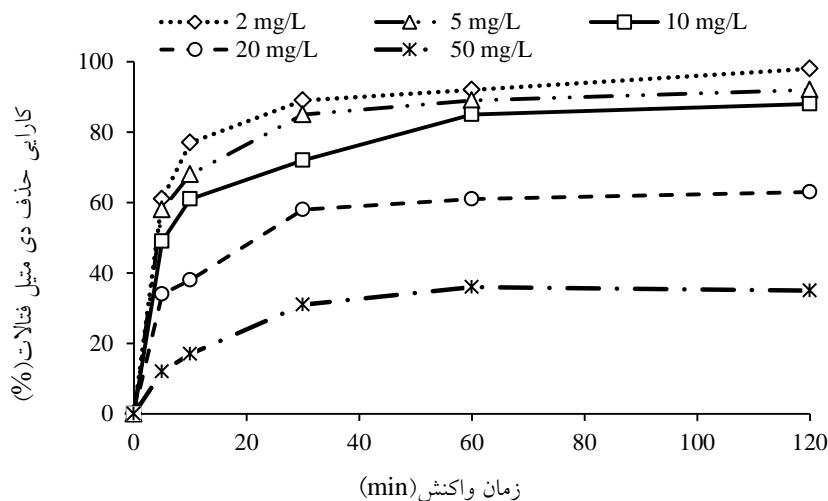
شکل ۴: تأثیر غلظت اولیه دی‌متیل‌فتالات در حذف آن ( $\text{pH}=4$ ، غلظت  $\text{H}_2\text{O}_2$ : ۰/۱ میلی‌مول در لیتر، دز نانوذرات آهن صفر: ۰/۰۵ گرم در لیتر)
