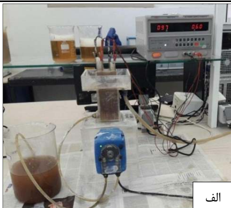
شکل ۱: شماتیک فرایند تصفیه فاضلاب حاوی سولفات توسط سیستم انعقاد الکتریکی (الف) و فاضلاب خروجی از سیستم با الکتروود آهن (ب)
