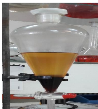
شکل ۱: تصاویر مربوط به دو فاز بیودیزل و گلیسرول تولیدی
