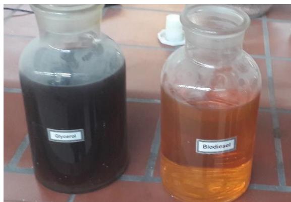
شکل ۱: تصاویر مربوط به دو فاز بیودیزل و گلیسرول تولیدی
