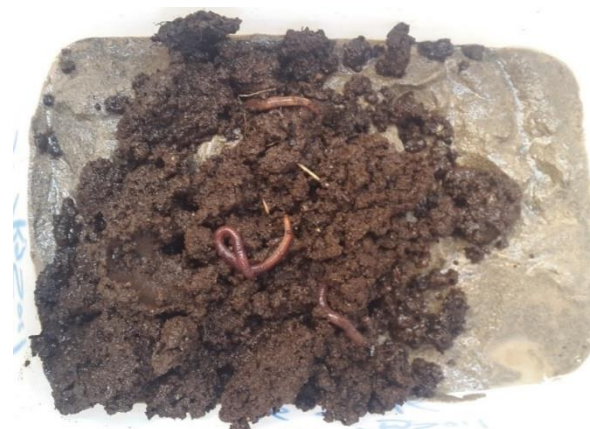
شکل ۲: محتویات داخل راکتورها شامل: خاک آلوده به گازوئیل+ورمی کمپوست+لجن فعال خام +کرم خاکی ایزنیافتیدا
