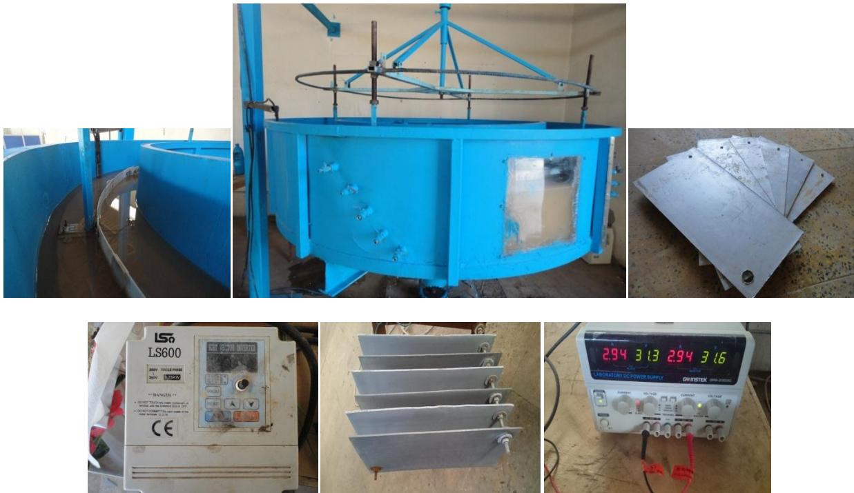
شکل ۱: مدل راکتور دوار به همراه محل قرارگیری الکتروودها
