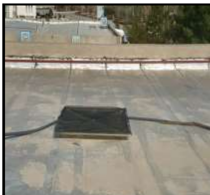
شکل ۲: تله مورد استفاده جهت جمع آوری گرد و غبار
